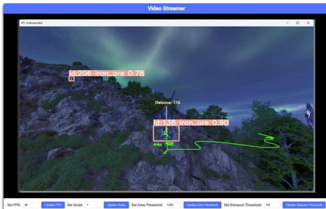
Рис. 4. Веб-интерфейс приложения Streamer. Предполагаемая траектория движения до следующего объекта – кривая линия
