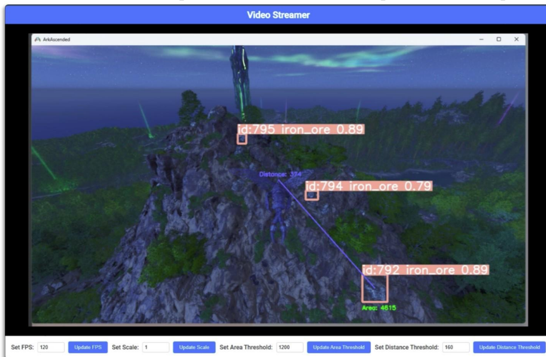
Рис. 3. Веб-интерфейс приложения Streamer. Выбор ближайшего объекта: линия проведена от центра кадра до центра выбранного объекта
